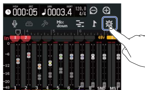
Pantalla de medidor de nivel
