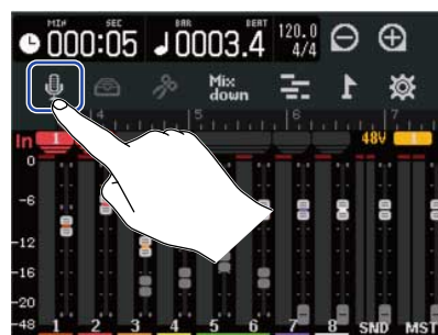
Pantalla de medidor de nivel
