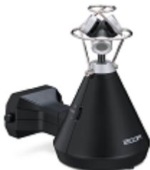
El VRH-8 es una cápsula de micro ambisónico que puede captar grabaciones de audio de 360° con cuatro micrófonos para producir dispersión vertical y profundidad fronto-posterior. Admite tres formatos de grabación de audio: AmbiX, FuMa y Ambisonics A.
