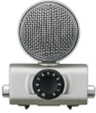
El MSH-6 es una cápsula de micro stereo de tipo centro-lateral con un micrófono unidireccional orientado hacia adelante (central) y uno bidireccional orientado hacia los lados (lateral). Puede cambiar libremente la amplitud stereo ajustando el nivel lateral MS.
