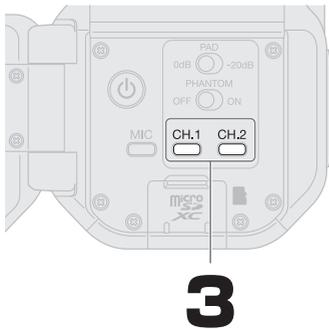
Pulse  CH.1 /  CH.2 para iluminar los canales a los que haya conectado los micros.
