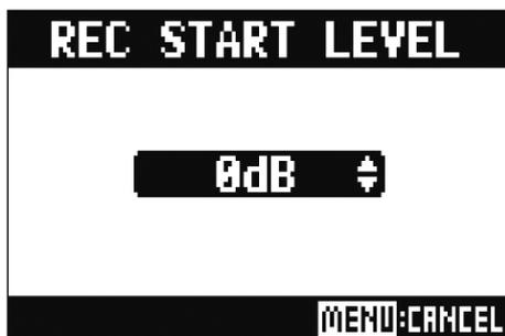
La grabación comenzará automáticamente cuando el nivel de la señal de salida del fader MASTER supere el nivel configurado aquí.
