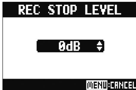
La grabación se detendrá de forma automática cuando el nivel de salida del fader MASTER permanezca por debajo del nivel configurado aquí durante el tiempo fijado en el paso 2.
