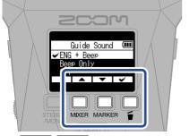
Use para elegir un elemento de ajuste y pulse para confirmarlo.
