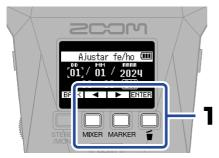
Elija un elemento de ajuste y pulse **ENTER** para confirmarlo.
