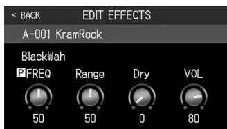
Para comprobar el parámetro ajustado con el pedal, toque en
