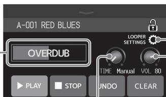
Toque para acceder a la pantalla de ajuste del looper. Podrá ajustar el valor mono/stereo, el método de parada y la posición del looper.
