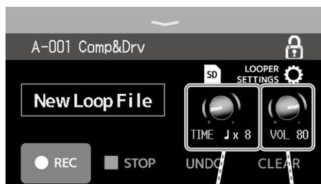
Puede modificar los ajustes del looper girando los mandos de parámetros y deslizando y pulsando los iconos en la pantalla táctil.
