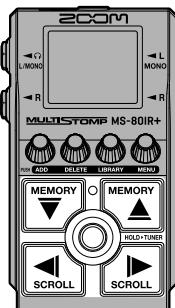
1. [ホーム画面](#)で / を押して、エフェクトをON/OFFしたいパッチメモリーを選択する（→[パッチメモリーを切り替える](#)）
