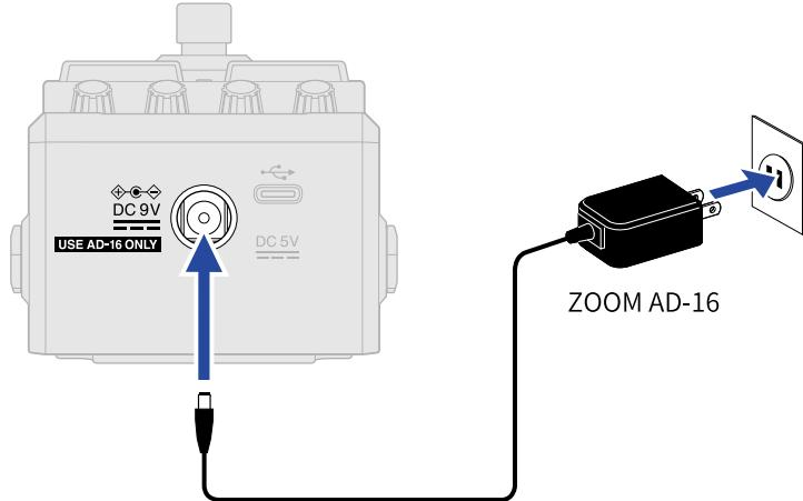
ACアダプターを接続すると、MS-80IR+の電源がONになります。
