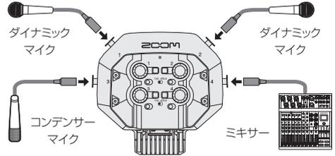
コンデンサーマイクなどファンタム電源を必要とする機器を接続する場合は、外部電源を使用してください。
