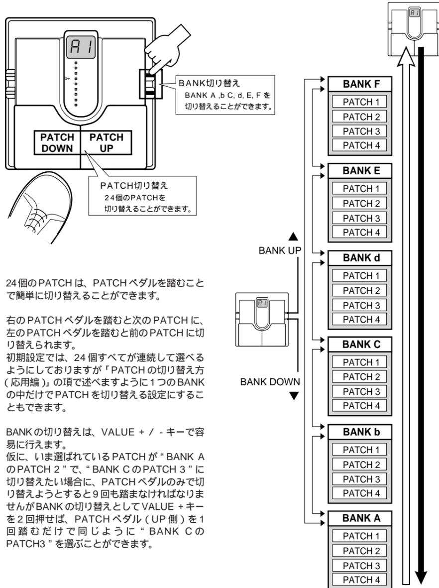
24個のPATCHは、PATCHペダルを踏むことで簡単に切り替えることができます。
