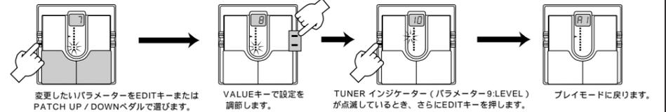
変更したいパラメーターをEDITキーまたはPATCH UP / DOWNペダルで選びます。 VALUEキーで設定を調節します。 TUNERインジケーター (パラメーター9:LEVEL) が点滅しているとき、さらにEDITキーを押します。 プレイモードに戻ります。
