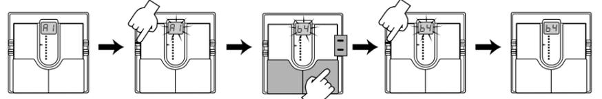
まず、PATCHをエディットします。 STOREキーを押します。(ストア待機状態) ストアしたいPATCHを選びます。 もう一度STOREキーを押して実行します。 ストア完了
