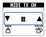
Si « RX » est sélectionné, le canal choisi pour la réception sera également utilisé pour l'émission. (→ Réglage du canal de réception MIDI (MIDI RX CH))
