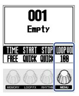
Cela règle le volume de la boucle dans la mémoire. Pour régler le volume global de la MS-90LP+, voir « Réglage du niveau général de sortie (OUTPUT VOLUME) ».
