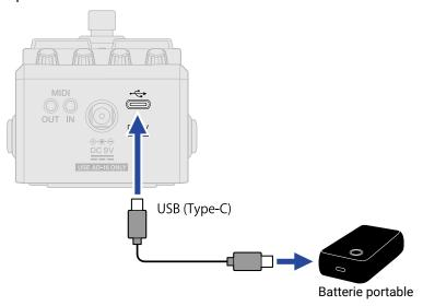
Lorsqu'une batterie portable est connectée, la MS-90LP+ s'allume.
