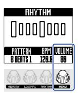
Cela règle le volume du rythme dans la mémoire. Pour régler le volume global de la MS-90LP+, voir « Réglage du niveau général de sortie (OUTPUT VOLUME) ».
