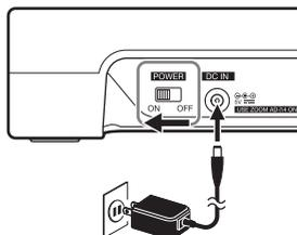
1. Schließen Sie das zugehörige Netzteil (AD-14) an eine Steckdose an.
