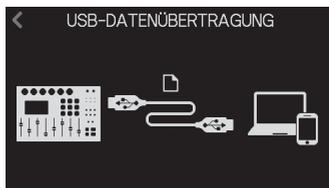
3. Verbinden Sie den **P8** über USB mit einem Computer, Smartphone oder Tablet (→ Seite 11).
