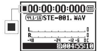
Der Counter wird auf 0 gesetzt.
