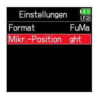
7. Wählen Sie mit (a) und (v) die Mikrofonausrichtung aus und drücken Sie (v).
