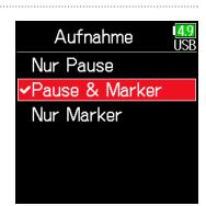
7. Wählen Sie mit und , wie Marker hinzugefügt werden, und drücken Sie .
