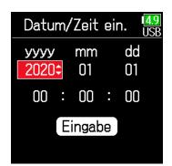
Wählen Sie abschließend mit und und den Eintrag Eingabe und drücken Sie (\*). Die Einstellung des Datums und der Uhrzeit ist abgeschlossen.
