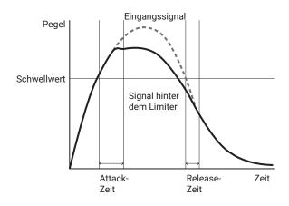
Bei aktiviertem Limiter wird das Eingangssignal bei Pegelwerten oberhalb des eingestellten Schwellwerts abgesenkt, um Verzerrungen zu verhindern.
