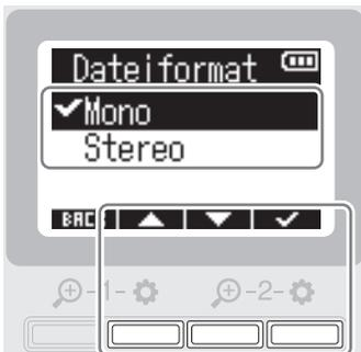
Abhängig von der Einstellung „Dateiformat“ wird das über Kopfhörer und die Line-Ausgänge abgehörte Audiosignal wie folgt umgestellt.
