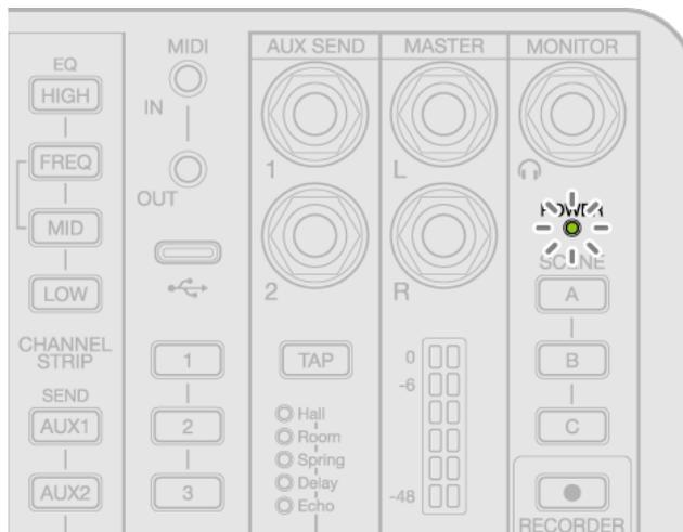
アップデートが完了すると <sup>POWER</sup>
